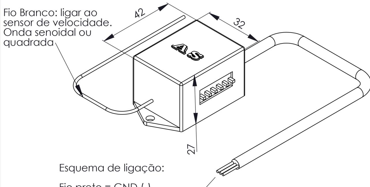
Fio Branco: ligar ao sensor de velocidade. Onda senoidal ou quadrada
